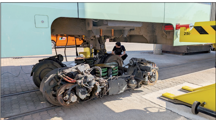
Erste Benutzung des mobilen Hebestands bei einer Skoda-Straßenbahnbahn.
